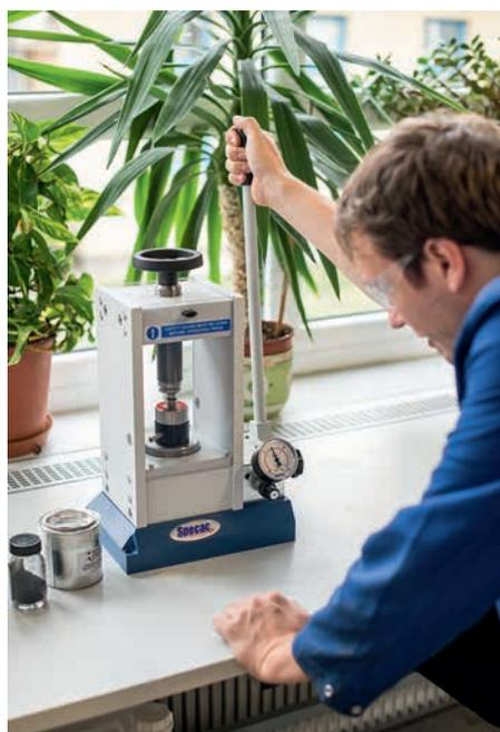
Laborant Manuel Nagl produziert an der Hydraulikpresse einen Kaliumbromid-Pressling zur IR-Analyse.
