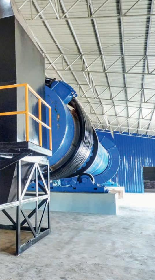
**Mindanao:** In langen Rohren entsteht aus vor-carbonisierten Kokoschalen, dem sogenannten „Char“, Aktivkohle.
