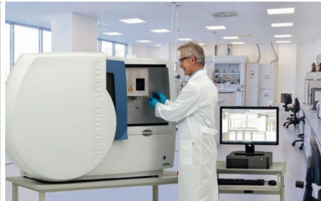
Mit dem neuen Spektrometer ist axiale und radiale Plasmabetrachtung möglich.
