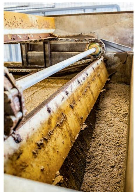
Beim Flotationsprinzip werden die Schwebstoffe von der Oberfläche abgekämmt.
