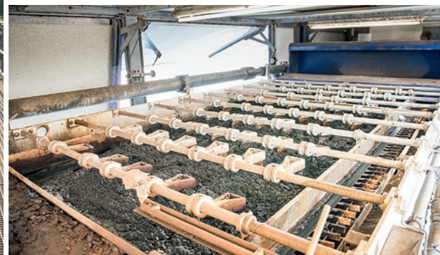
In Gols/Mönchhof wird das Abwasser in zwei Stufen biologisch gereinigt – eine Besonderheit. Die mobile Presse bereitet den Klärschlamm für die Kompostierung auf (unten).
