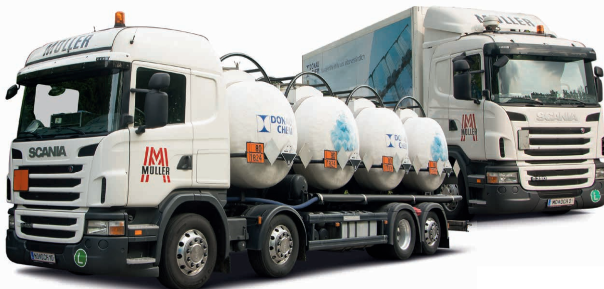
Effektive Brummis: 4-achsiger, 16.000 l fassend, lärm- und schadstoffarm.
