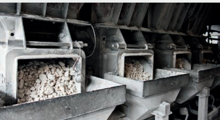
Aus dem Brenngas, das bei der Karbidproduktion frei wird, entstehen jedes Jahr 26.000 Tonnen Kalk.
