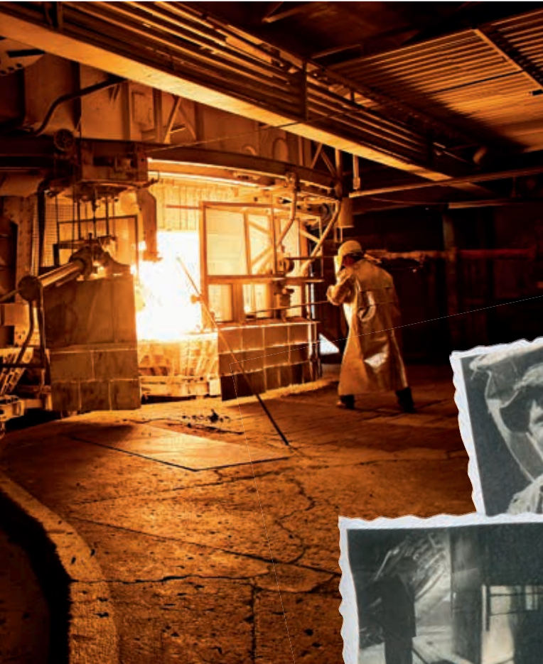
Heiße Sache: Beim Abstich hat das Karbid immer noch 1.700° C. Heute (links) wie damals (unten).
